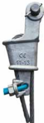
Capocorda autobloccante con morsetto Efficienza applicazione: 80% del MBF fune
