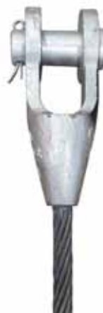
Capocorda aperto testa fusa Efficienza applicazione: 100% del MBF fune
