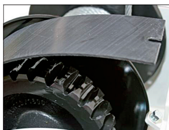
Particolare del riduttore. Reduction system.
