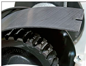
Particolare del riduttore. Reduction system.
