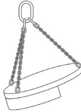
Figura 15: Tutto il carico è supportato da due bracci
