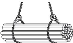
Figura 12: imbragatura a scorsoio e ganci con orientamento contrapposto
