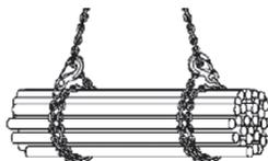
Figura 13: imbragatura a scorsoio con avvolgimento del carico e ganci con orientamento contrapposto
