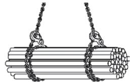
Figura 11: imbragatura a scorsoio con avvolgimento del carico e ganci con uguale orientamento
