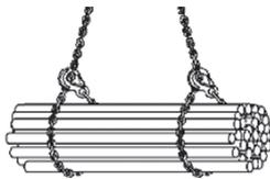
Figura 10: imbragatura a scorsoio e ganci con uguale orientamento
