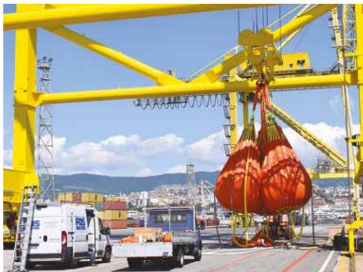
**Il principio** è quello di fornire dei palloni di pesi molto ridotti, che riempiti con acqua raggiungono portate molto elevate, senza limiti.
